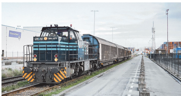
Рис. 10. Тестирование грузового поезда с системой АТО, соответствующей уровню автоматизации GoA2
