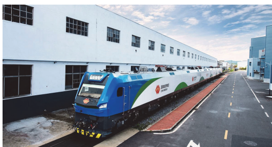
Рис. 19. 24-осный шестисекционный электровоз Shen-24
