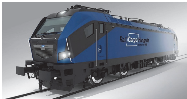
Рис. 20. Локомотив с гибридным тяговым приводом, оснащенный тяговыми литиевыми аккумуляторными батареями
