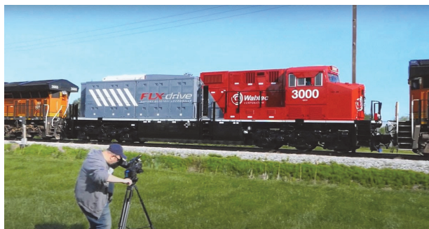
Рис. 18. Испытания опытного образца аккумуляторного локомотива мощностью 4400 л. с.
